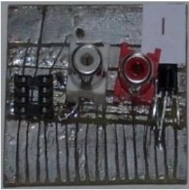
Ilustración 1: Cara frontal del módulo DigiTodo. Zócalo EEPROM 1, entrada de señal (conector RCA blanco), salida de señal (conector RCA rojo), y receptor de infrarrojos.
