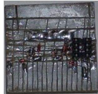
Ilustración 3: Reverso del módulo mostrando el zócalo EEPROM número 0.
